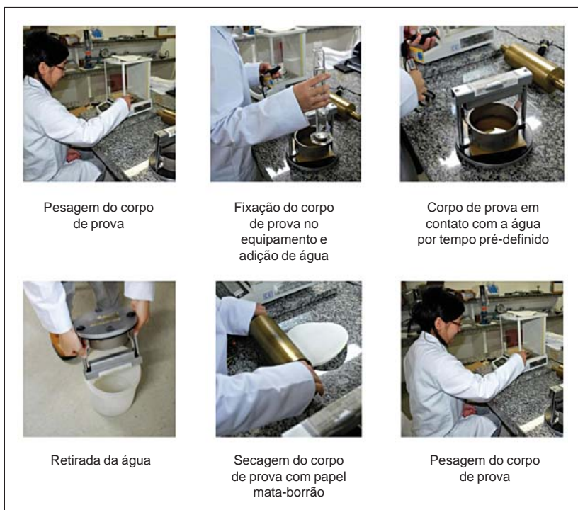
Figura 4.13: Sequência de realização do “Método Cobb”.
